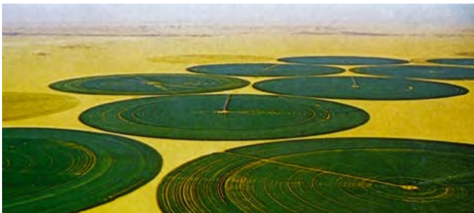
Мал. 27. Зрошення ланів у Лівійській пустелі. Дощувальне устаткування рухається по колу, а повний оберт робить за 3–4 дні
